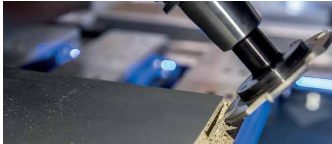
P-System Profilnut Fräsung mit der Homag Venture 316 L CNC 5-Achs
